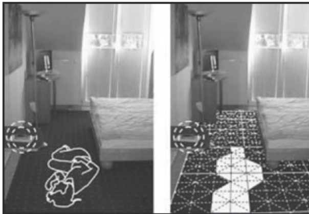
Abb. 7: SensFloor löst einen Notruf aus, wenn eine gestürzte Person nicht wieder aufsteht; Quelle: connected-home.de
