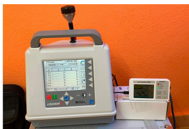
Abb. 3: Kita Kindervilla (Raum Landgrafenbergblick) Messaufbau Fensterlüftung Partikelmessgerät und CO_2 -Datenlogger
