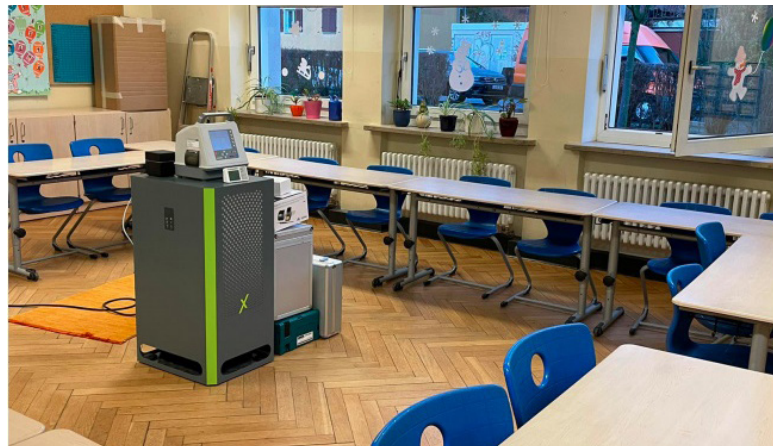
Abb. 4: Südschule (Raum 00_18) Raumluftreiniger mit HEPA-14-Filter; Volumenstrom ca. 650 m^3/h (Quelle: Stadt Jena KIJ)
